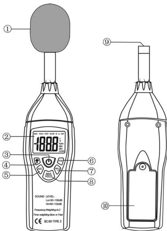
1. Espuma de cobertura para quando a velocidade do vento for acima de 10m/S.
