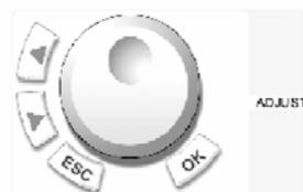
**Fig. 5** Chave Giratória e Teclas de função.
